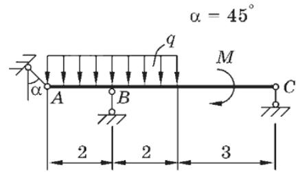
*3.Применение стандартных методов расчета при проектировании деталей и узлов технологических машин и оборудования. Задача на определение реакций связей.*
