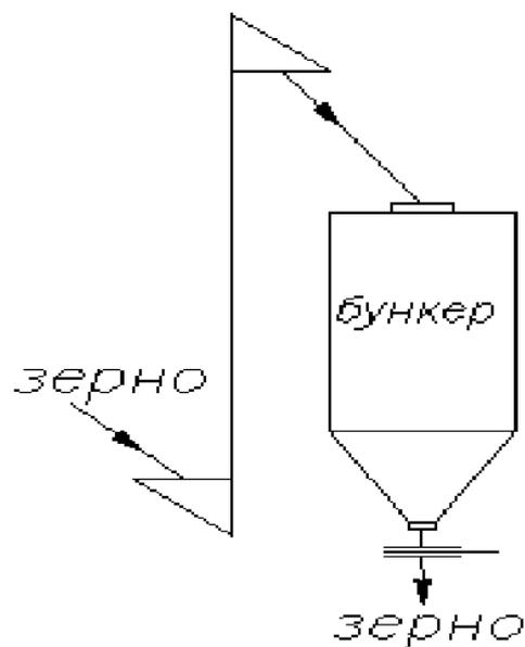
Рисунок 7.6 – Подача зерна в бункер норией
