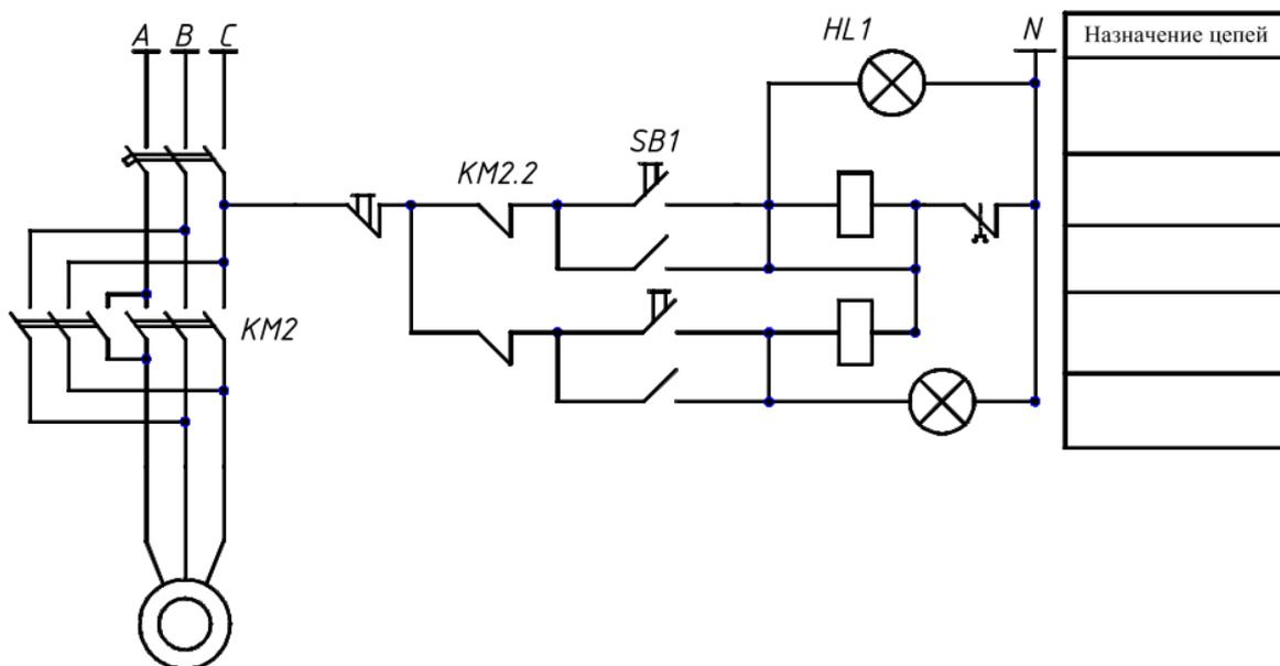
Рисунок 2.2.5 – Принципиальная электрическая схема управления электроприводом задвижки.
