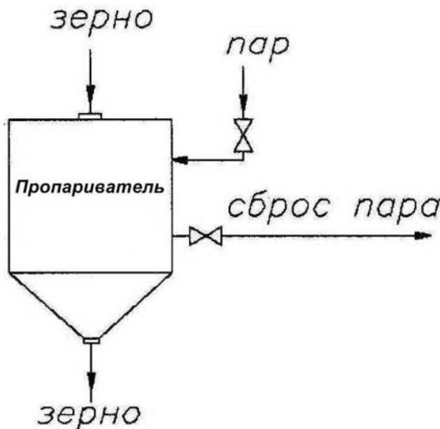
Рисунок 7.14 – Пропаривание зерна
