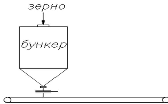
Рисунок 7.4 – Подача зерна из бункера на конвейер
