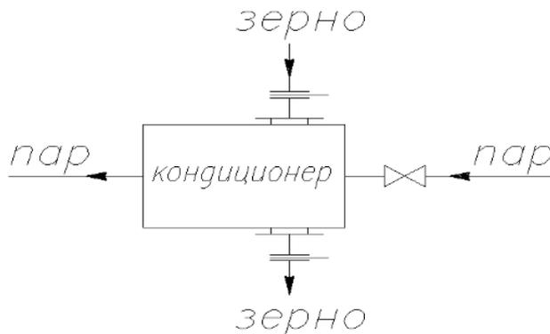
Рисунок 7.18 – Скоростной кондиционер для укрепления слабой клейковины
