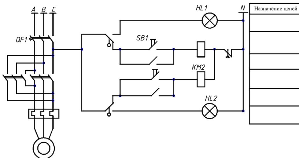
Рисунок 2.2.9 – Принципиальная электрическая схема управления электроприводом задвижки.
