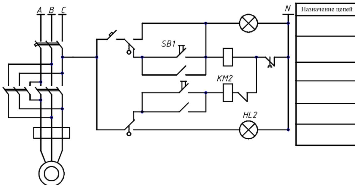
Рисунок 2.2.11 – Принципиальная электрическая схема управления электроприводом задвижки.
