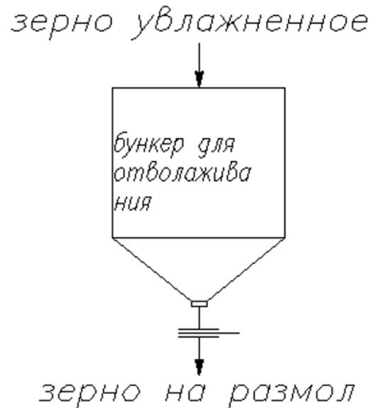
Рисунок 7.12 – Отволаживание зерна
