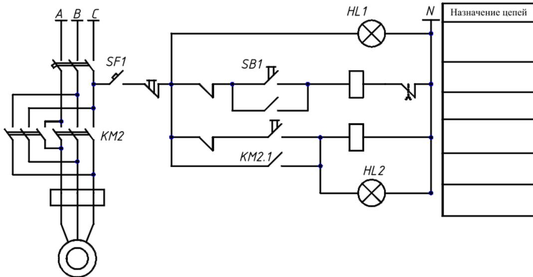
Рисунок 2.2.1 – Принципиальная электрическая схема управления электроприводом задвижки.
