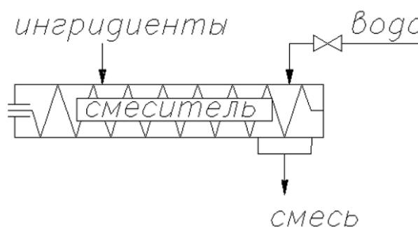
Рисунок 7.2 – Смешивание компонентов для производства комбикормов
