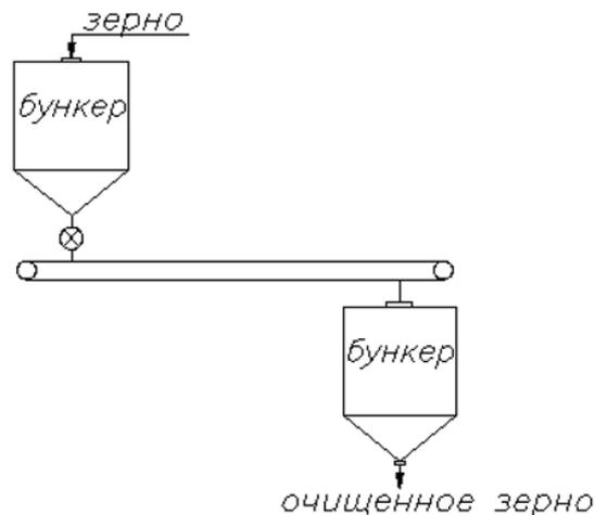
Рисунок 7.10 – Подача зерна из бункера в бункер
