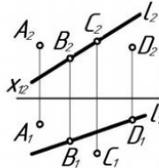
6. Обосновывая применение и используя программные продукты, в том числе с учетом требований информационной безопасности, построить комплексный чертеж отрезка AB, если A(10; 20; 35), B(45; 0; 10), найти на отрезке точку C, при условии, что высота точки равна 25 мм.
