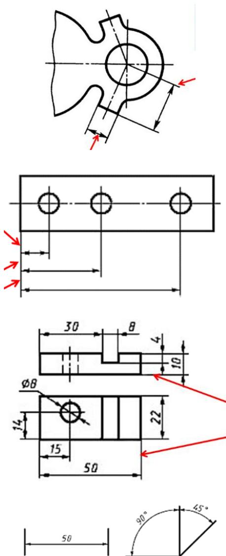
2. Обосновывая применение и используя программные продукты, в том числе с учетом требований информационной безопасности, вычертить примеры типов размеров, применяемых при выполнении эскиза или рабочего чертежа детали.
