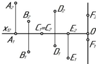
3. Обосновывая применение и используя программные продукты, в том числе с учетом требований информационной безопасности, по комплексному чертежу определить как расположена каждая прямая относительно плоскостей проекций.
