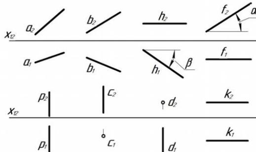
4. Обосновывая применение и используя программные продукты, в том числе с учетом требований информационной безопасности, по комплексному чертежу определить как расположена каждая прямая относительно плоскостей проекций.
