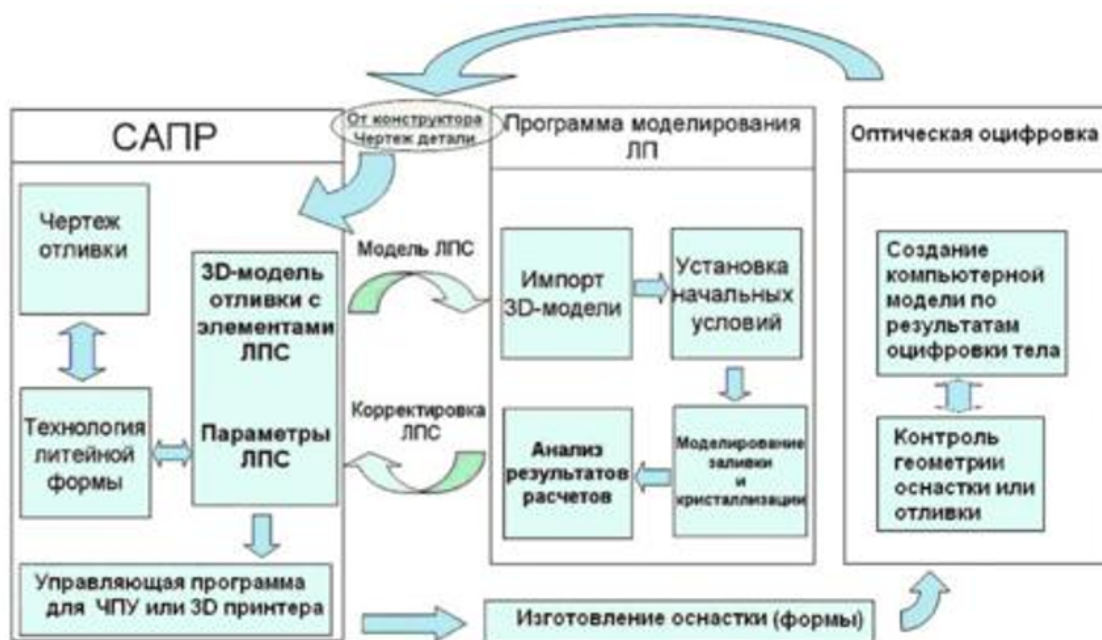
Рис. 1 – Схема процесса компьютерной разработки технологии производства отливки
