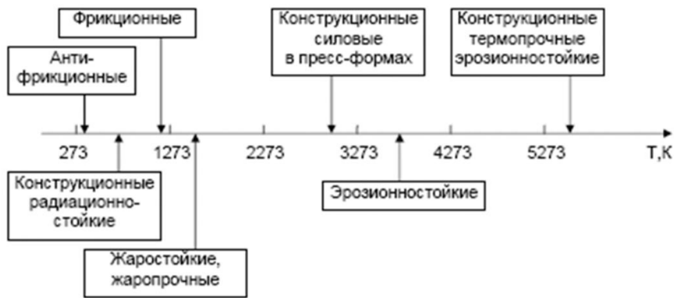
Рис. 3 Основные свойства углерод-углеродных композитов в зависимости от температуры
