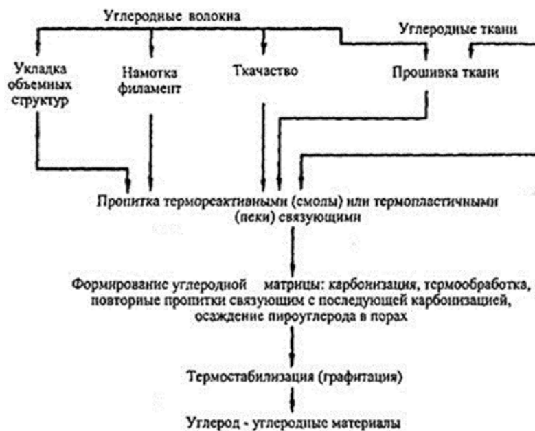
Рис. 2 Общая технологическая схема производства углерод-углеродных КМ
