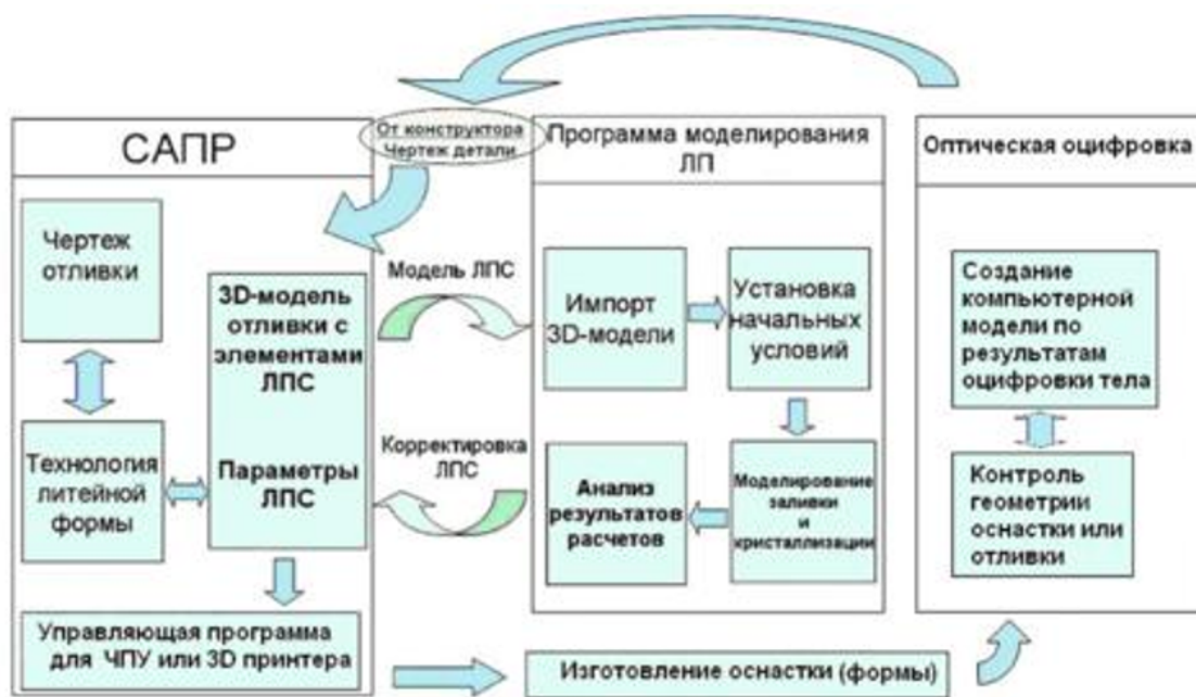
Рис. 1 – Схема процесса компьютерной разработки технологии производства отливки
