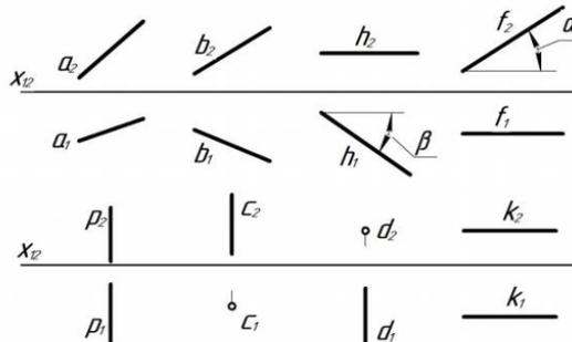
4. Выбирая нормативные требования к документации и применяя нормативные требования при разработке проектной и конструкторской документации, по комплексному чертежу определить как расположена каждая прямая относительно плоскостей проекций.
