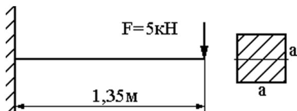
Задача №6: 3 Выполнить расчет с применением знаний о свойствах конструкционных и электротехнических материалов, а именно - определить максимальный прогиб стальной балки способом Верещагина.
