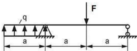
Задача №3 Выполнить расчет с применением знаний о свойствах конструкционных и электротехнических материалов, а именно - основных законов механики и определить необходимое количество стальных заклепок допускаемым напряжением 120 МПа и диаметром 4 мм, если  $F=10 \text{ кН}$ .
