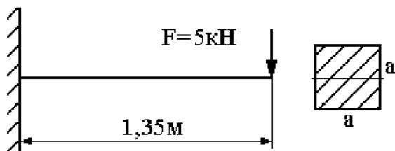
Задача №9: 3 Выполнить расчет с применением знаний о стандартных методах расчета при проектировании деталей и узлов технологических и машин и оборудования , а именно - определить максимальный прогиб стальной балки способом Верещагина.
