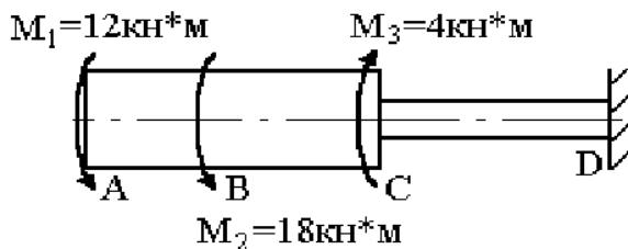
Задача №8: Выполнить расчет с использованием полученных знаний о стандартных методах расчета при проектировании деталей и узлов машин, а именно: определите максимальный прогиб стальной балки методом начальных параметров при  $a=10$  см.
