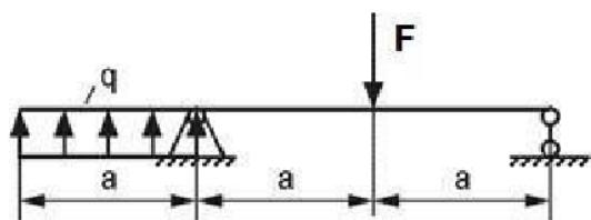
Задача №3 Выполнить расчет с применением знаний о стандартных методах расчета при проектировании деталей и узлов технологических и машин и оборудования, а именно - основных законов механики и определить необходимое количество стальных заклепок допускаемым напряжением 120 МПа и диаметром 4 мм, если  $F=10 \text{ кН}$ .
