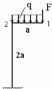
Задача №12: Выполнить расчет с применением знаний о стандартных методах расчета при проектировании деталей и узлов технологических и машин и оборудования, а именно - для заданной статически неопределенной стержневой системы методом допускаемых напряжений определить максимальную нагрузку F. Считать, что первый стержень изготовлен из двутавра №14, а второй из швеллера №8.
